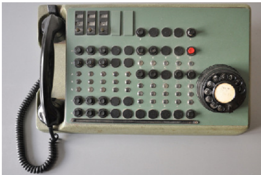
Sog. Telefonzentrale (1960er Jahre) mit Wählscheibe.
